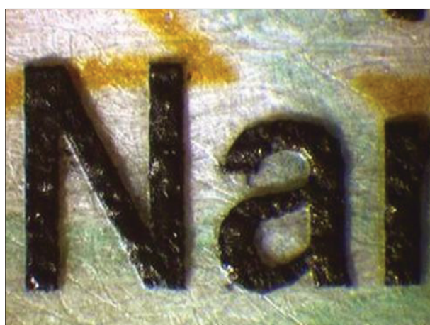
Figure 5 : Lumière rasante produisant des effets ombrés dus au relief de l'impression taille-douce
