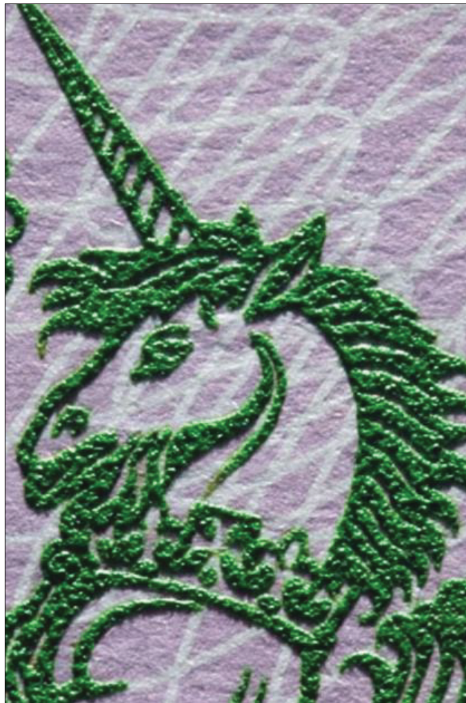
Figure 18 : Motif imprimé en taille-douce, visible en lumière rasante et révélant un effet de relief
