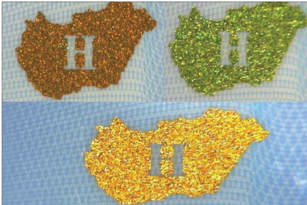
Figure 21 : Encre optiquement variable appliquée par sérigraphie
