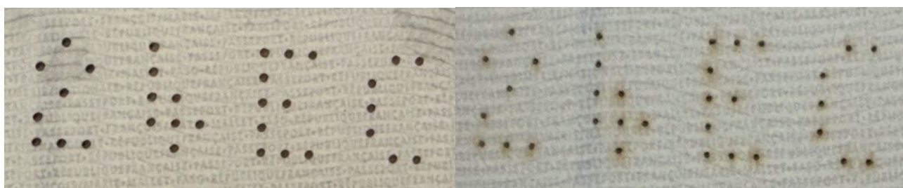
Figure 16 : Perforation laser de la première et dernière page d'un passeport français
