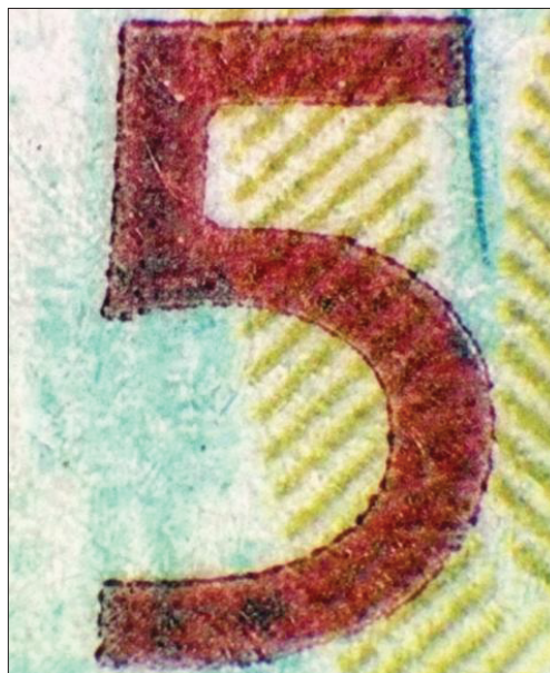
Figure 20 : Numéro de série imprimé en typographie
