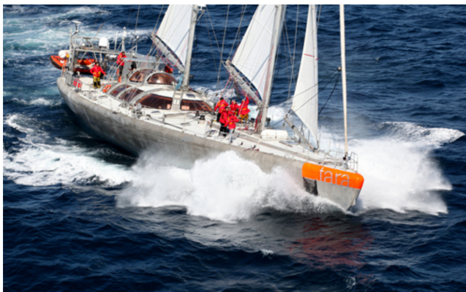
La Goélette Tara , L=36 m est le plus grand dériveur polaire du monde. Il est conçu pour résister à la compression des glaces en mouvement et aux très basses températures.
